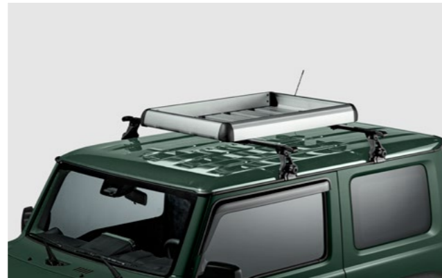
Art.-Nr. 99177-78R00-000 Einfache Montage direkt auf dem Grundträger. Max. Dachlast 30 kg. Eigengewicht: 8,0 kg. Abmessungen: 105,2 cm × 75 cm × 10 cm.
